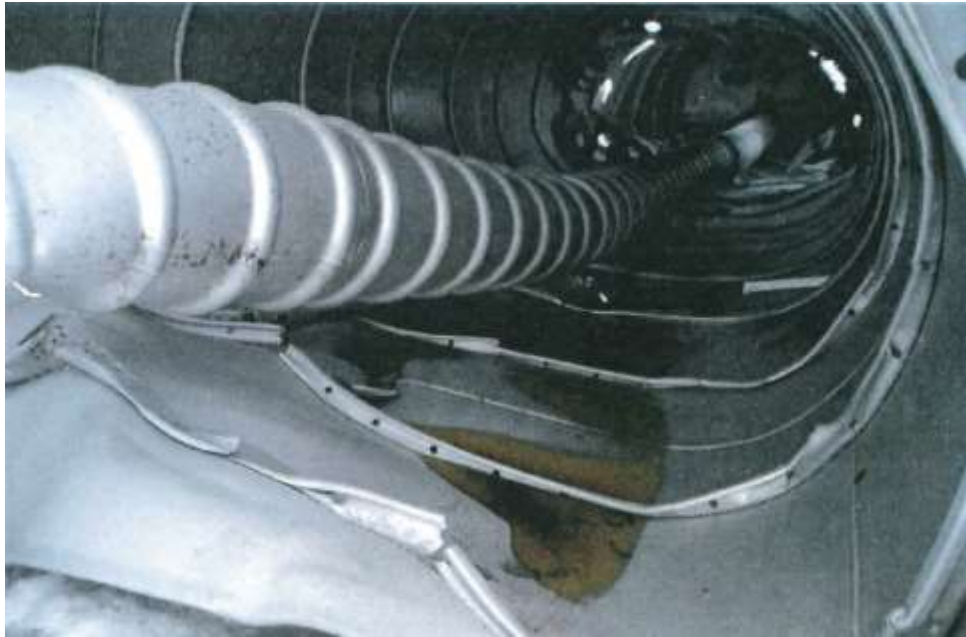
Рисунок 5.4- Бак горючего (с остатками топлива Т-1)
